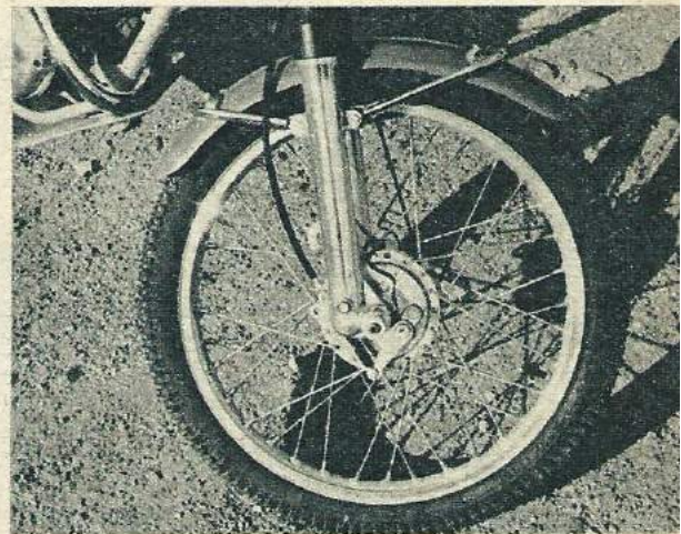
Detalle freno delantero, con el guardapolvos del cable del mismo en la parte inferior.
